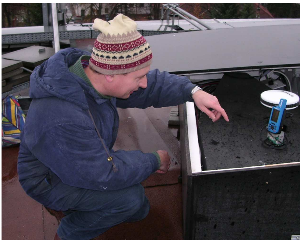
foto 6 – Diferenciální GPS stanice a její obslužný pracovník
